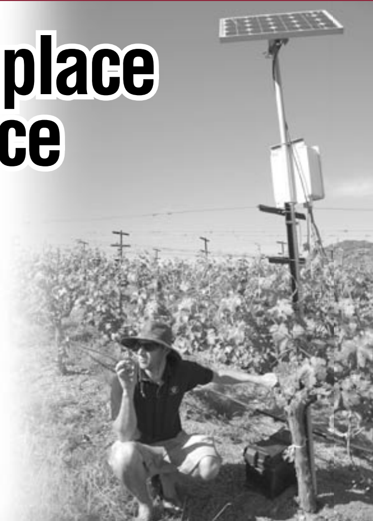
Benoit Touquette près d'une station météorologique et de transmission sans fil des données du capteur de flux de sève.
